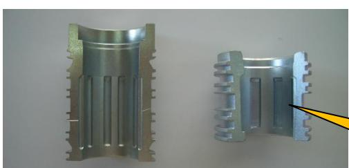
鍛造による内径の袋溝加工
